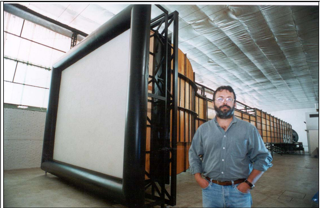
Figura 1.1: Túnel de vento atmosférico desenvolvido pelo Instituto de Pesquisa Tecnológicas do Estado de São Paulo para simular a camada limite planetária na região de Iperó.
