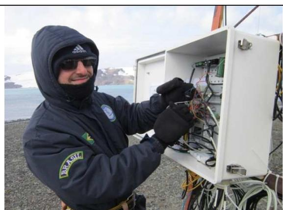
**Figura 1b:** Instalação dos instrumentos ao sistema de aquisição de dados (datalogger CR5000 da Campbell Scientific Inc).
