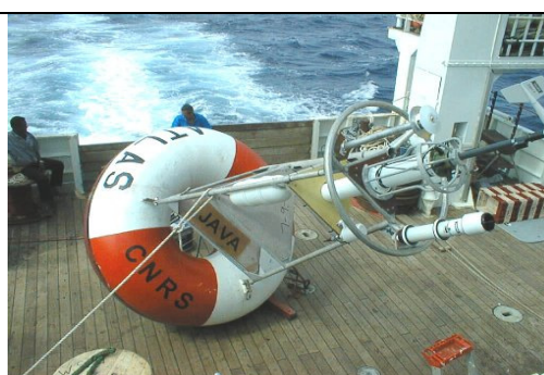
Figura 4: Bóia PIRATA utilizada na aquisição das variáveis meteorológicas e oceanográficas.
