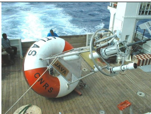
Figura 2: Bóia PIRATA utilizada na aquisição das variáveis meteorológicas e oceanográficas.
