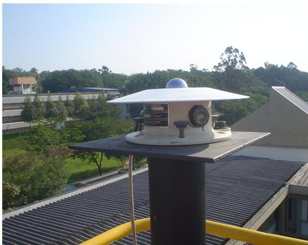
Figura 3: Pirgeômetro da Eppley modelo PIR
