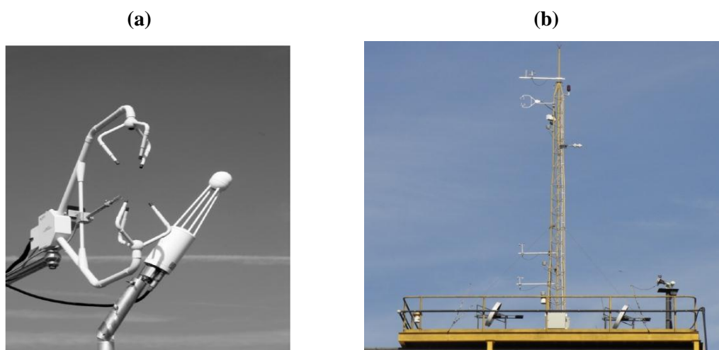
Figura 1: (a) Anemômetro sônico CSAT3 da Campbell e analisador infravermelho de gases da LICOR e (b) Plataforma Micrometeorológica do IAG da USP.
