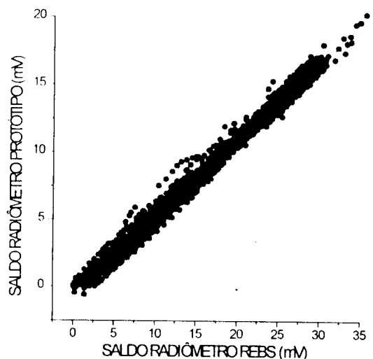
Figura 4: Curva de resposta do saldo radiômetro
